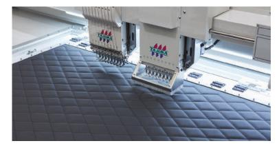
Grâce à un système d'aspiration innovant, la machine perce le cuir sans laisser aucune trace de saleté ou de déchets sur la zone de travail.
